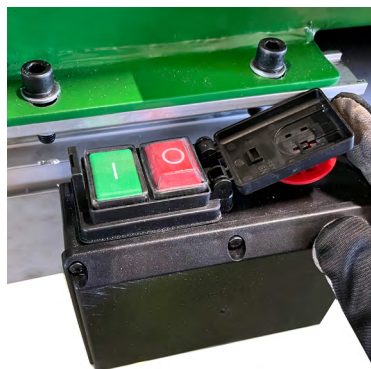
Virtakytkin. POIS PÄÄLTÄ / PÄÄLLE
