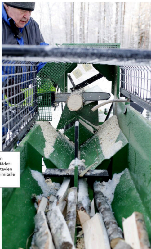
Katkaisusahan käsittelyyn tarvitaan kaksi kättä. Näin rangan pitelyyn tarvitaan apuhenkilö.
