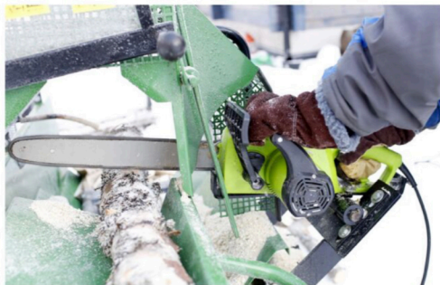
Katkaisusahan käsittelyyn tarvitaan kaksi kättä. Näin rangan pitelyyn tarvitaan apuhenkilö.
